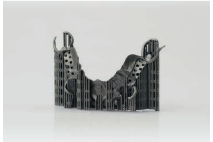
Abb. 12: Modellgussprothese, hergestellt aus EOS CobaltChrome RPD mit Supportstrukturen
