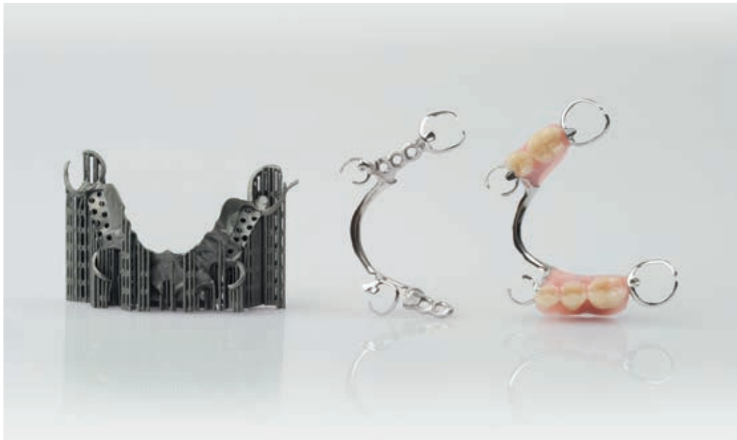
Abb. 7: Fertigungsschritte einer lasergesinter- ten Modellgussprothese: Zahnersatz direkt nach dem Bauprozess, Support- strukturen entfernt und Oberfläche poliert, nach Fertigstellung (v. l. n. r.)
