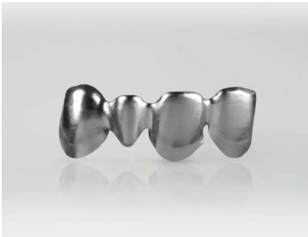
Abb. 11: Polierte Brücke hergestellt aus EOS CobaltChrome SP2
