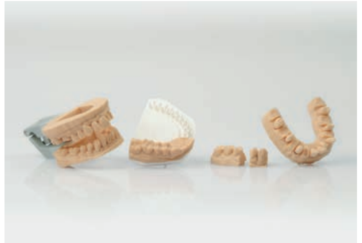
Abb. 6: Designvielfalt durch digitale Fertigung: Vollgefertigtes Ganzkiefermodell zur Okklusionskontrolle, Sägeschnittmodell mit Pinlöchern, Modell mit herausnehmbaren Stümpfen (v. l. n. r.)
