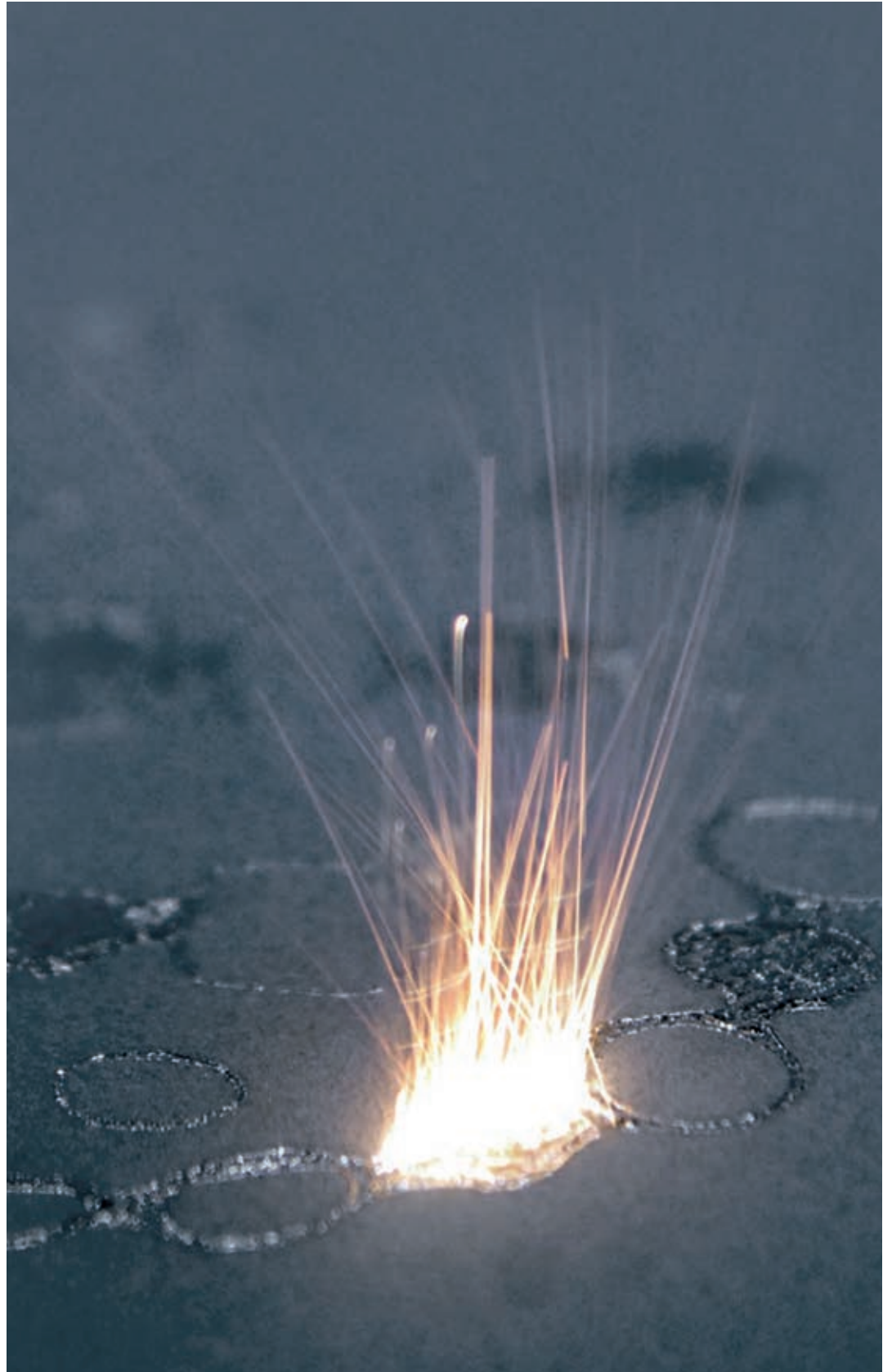
Abb. 8: Digitale Fertigung: Mit 200 W und einer Temperatur von 1400 °C verschmilzt der Laser Schicht für Schicht das Metallpulver
