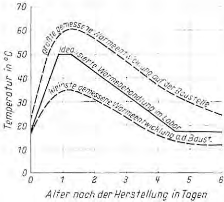
Bild 3 Temperaturverlauf (maximaler und minimaler Wert) in einer Wand eines Spannbetonbehälters und idealisierte Wärmebehandlung für Laboruntersuchungen [11]
